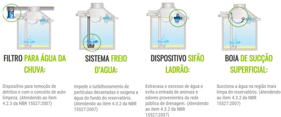
Figura 4. Equipamentos e Processo de Sistema de Aproveitamento da Água de Chuva.
